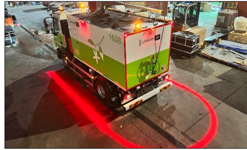
Imagen 22. Sistema perimetral de iluminación
