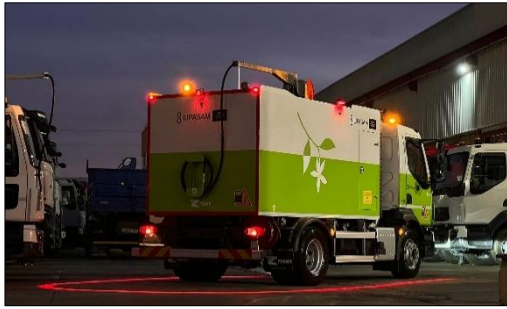
Imagen 21. Sistema perimetral de iluminación
