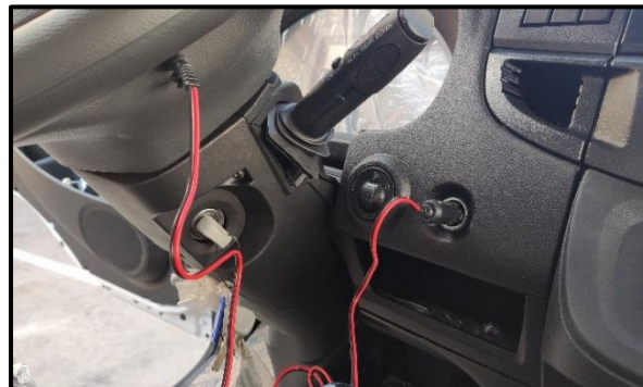
Imagen 16: Carga de los joysticks en volante
