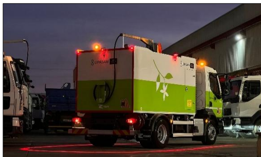
Imagen 21. Sistema perimetral de iluminación
