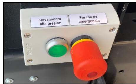
Imagen 28. Detalle botonera alta presión
