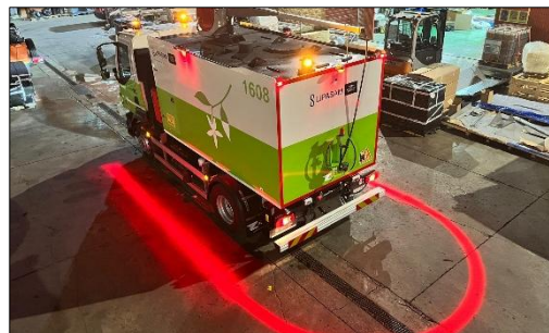
Imagen 22. Sistema perimetral de iluminación
