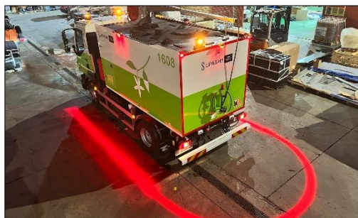
Imagen 22. Sistema perimetral de iluminación
