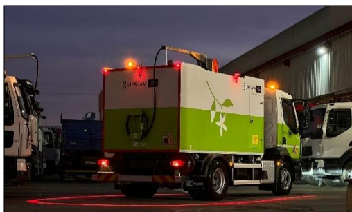
Imagen 21. Sistema perimetral de iluminación
