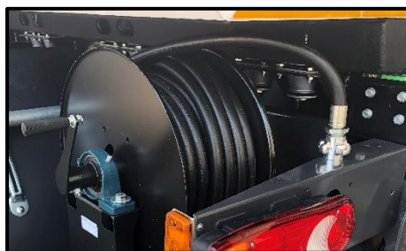
Imagen 32. Detalle devanadera recogida
